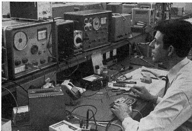
De heer Pansma van DMBI bezig met het repareren en afregelen van portofoonapparatuur
