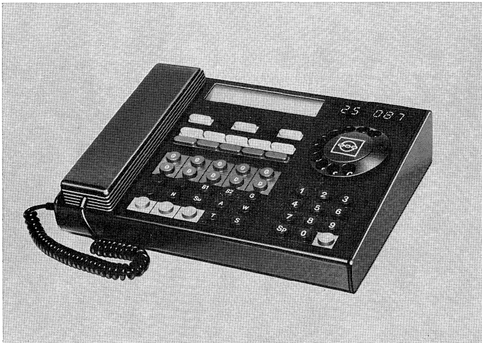
Bedieningslessenaar van de EBX-100 bedrijfs-telefooncentrale met 10 netlijnen.
